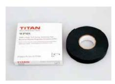
Модель WPMS - хорошо прилегающая, самовулканизирующаяся изоляционная лента на основе этиленпропиленовой резины. Её можно использовать как при низком так и при высоком напряжении. Может применяться для изоляции соединительных муфт и муфт концевой заделки кабелей. Имеет специальную ленту предотвращающую склеивание.
